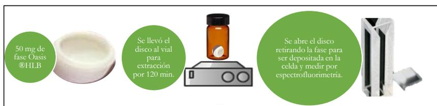
Figura 10. Esquema del método propuesto por RDSE directo para la determinación de EFX, CFX y OTC.
