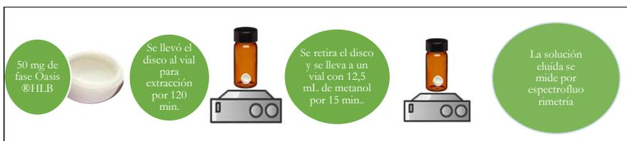
Figura 11. Esquema del método propuesto por elución de RDSE, para la determinación de EFX, CFX y OTC.
