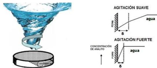
Figura 9. Efecto de la velocidad de rotación.
