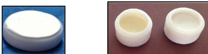
Figura 8. Configuraciones RDSE, izquierda disco plano y derecha disco con cavidad.
