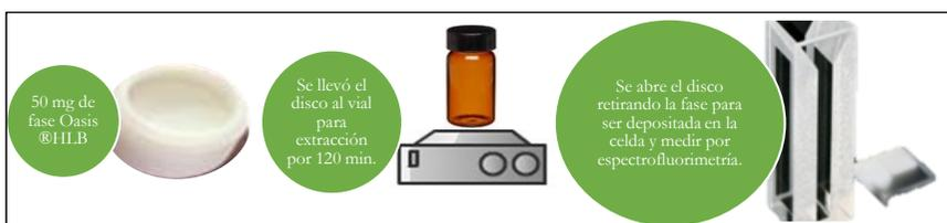
Figura 23. Esquema del método propuesto por RDSE para la determinación de EFX, CFX y OTC.
