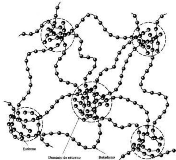
**Figura 6.** Estructura del copolímero estireno-butadieno en un elastómero termoplástico. La naturaleza vítrea de los dominios de estireno le da un comportamiento elástico, sin enlaces cruzados del butadieno <sup>(44)</sup>.
