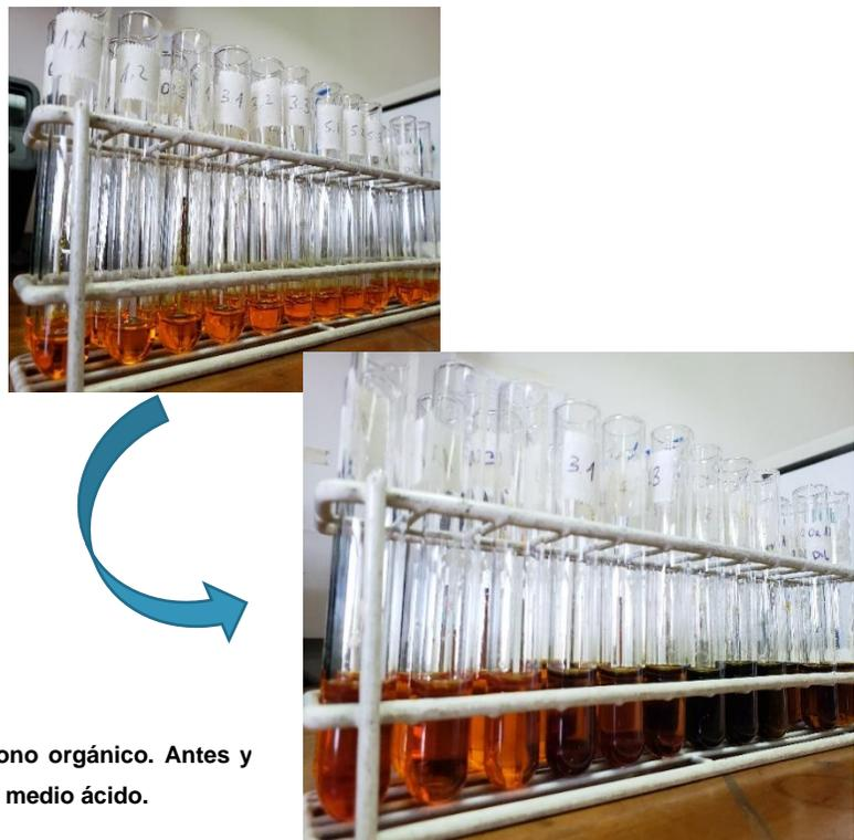
**Figura 6** Determinación de carbono orgánico. Antes y después de la oxidación del C en medio ácido.
