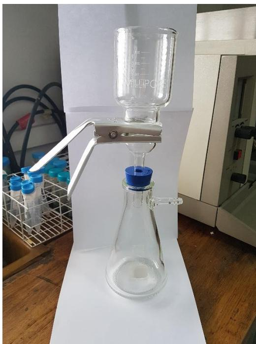
Figura 9 Sistema de SPE con disco
