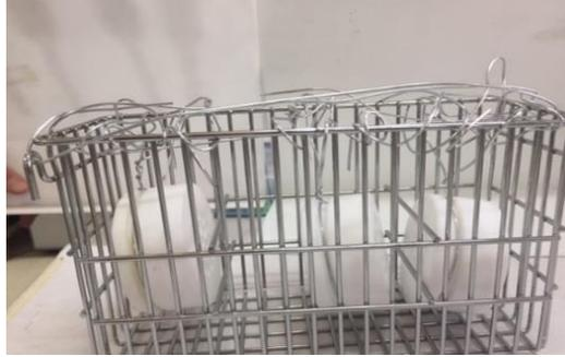
Figura 31. Muestreadores colocados en una canastilla de acero para su disposición y muestreo.
