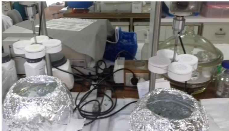
Figura 15. Montaje de muestreadores antes de ser sumergidos en soluciones enriquecidas con los analitos en estudio y con agitación vertical para la estimación de las Rs en laboratorio.
