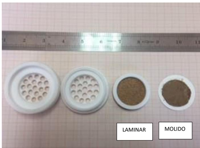
Figura 21. Muestreador pasivo y las fases corcho laminar y molido.
