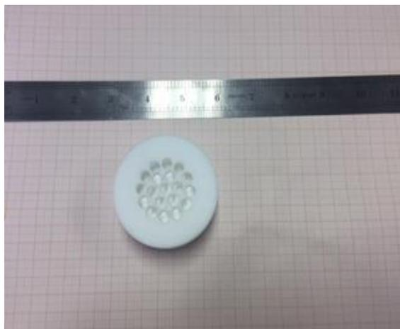
Figura 20. Muestreador pasivo armado con PES en su interior
