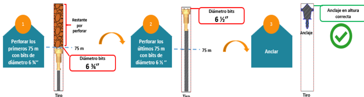
Figura 55: Implementación de cambio de diámetro de perforación en CUBEX y HRI.
