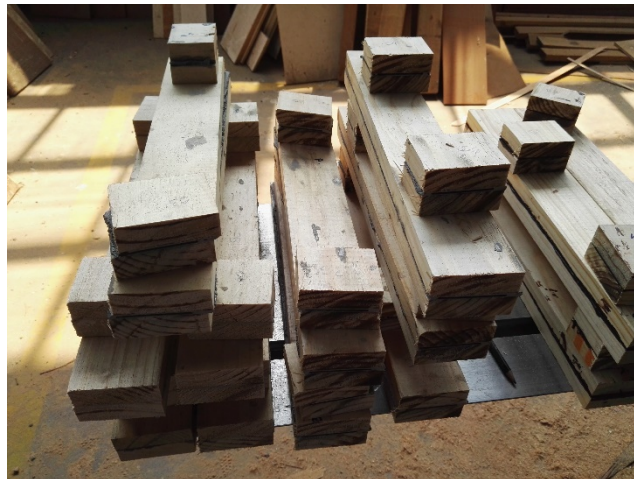
Figura 5: Muestras de cizalle sobre maderas pegadas con refuerzo de fibra de carbono
