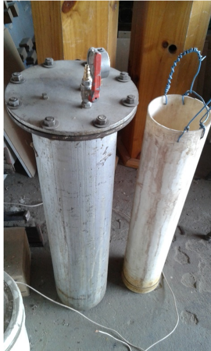
Figura 12: Cilindro de impregnación con válvula en la parte superior, donde se conectará con el compresor
