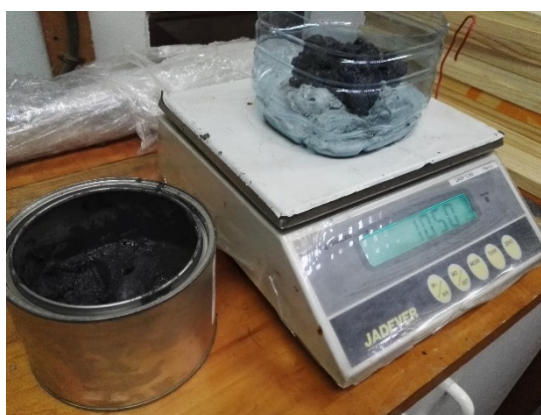
Figura 1: Preparación adhesivo Sikadur 30 (Parte A+B)
