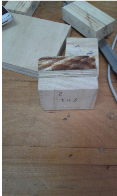
Figura 20: Probeta testigo resorcinol 11, con falla en madera y no en línea de cola
