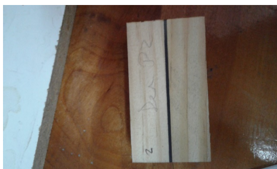
Figura 10: Probeta con refuerzo pegada con Poliuretano para ensayo de delaminación
