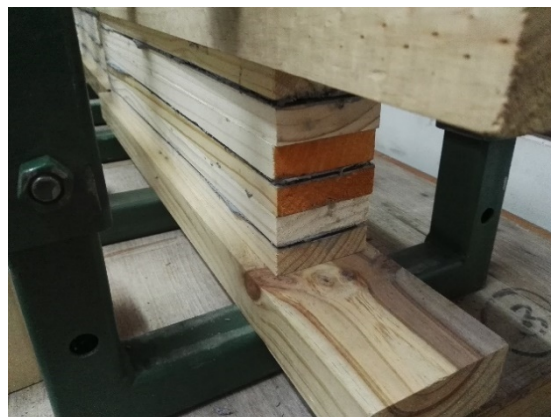
Figura 3: Prensado muestras pegadas con Sikadur 30 desde otro ángulo
