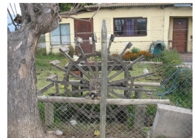
Pequeña azuda construida con materiales reciclados, la cual riega un reducido jardín en el sector La Torina. IHP, 2013.
