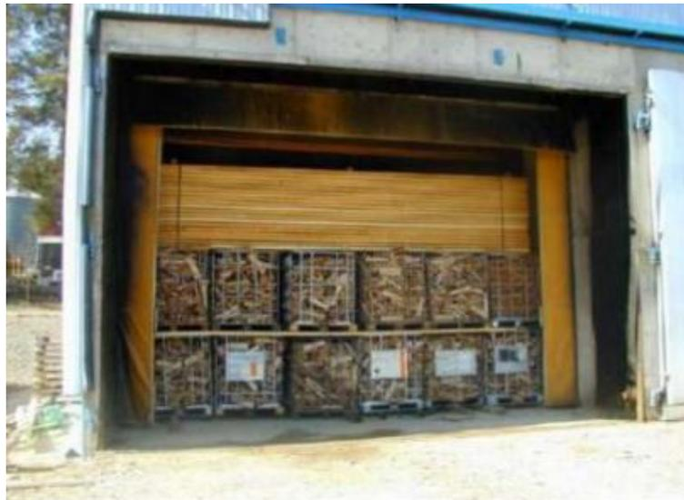
Figura 2.16: Dos capas de leña bajo madera aserrada en una cámara de secado artificial convencional de un aserradero en Finlandia [25].
