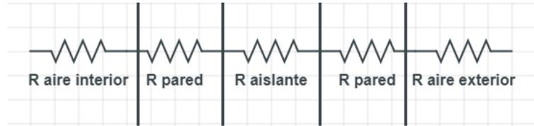
Figura 4.2: Red de resistencias térmicas para las paredes de la cámara de secado.
