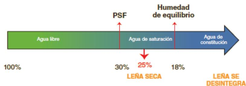
Figura 2.10: Proceso de secado de leña. Fuente: Manual de técnicas para el secado y monitoreo de leña.
