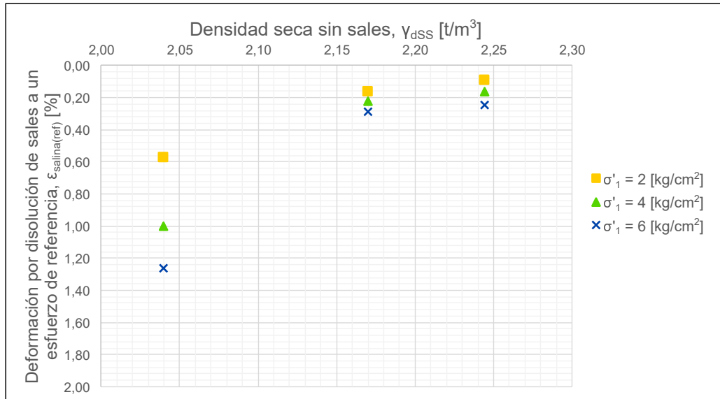
Figura 6.9: Densidad seca sin sales vs deformación por disolución de sales a un esfuerzo de referencia. Campañas A, B y C. (Sobre \gamma_{dSS} = 2,0 [t/m 3 ])
