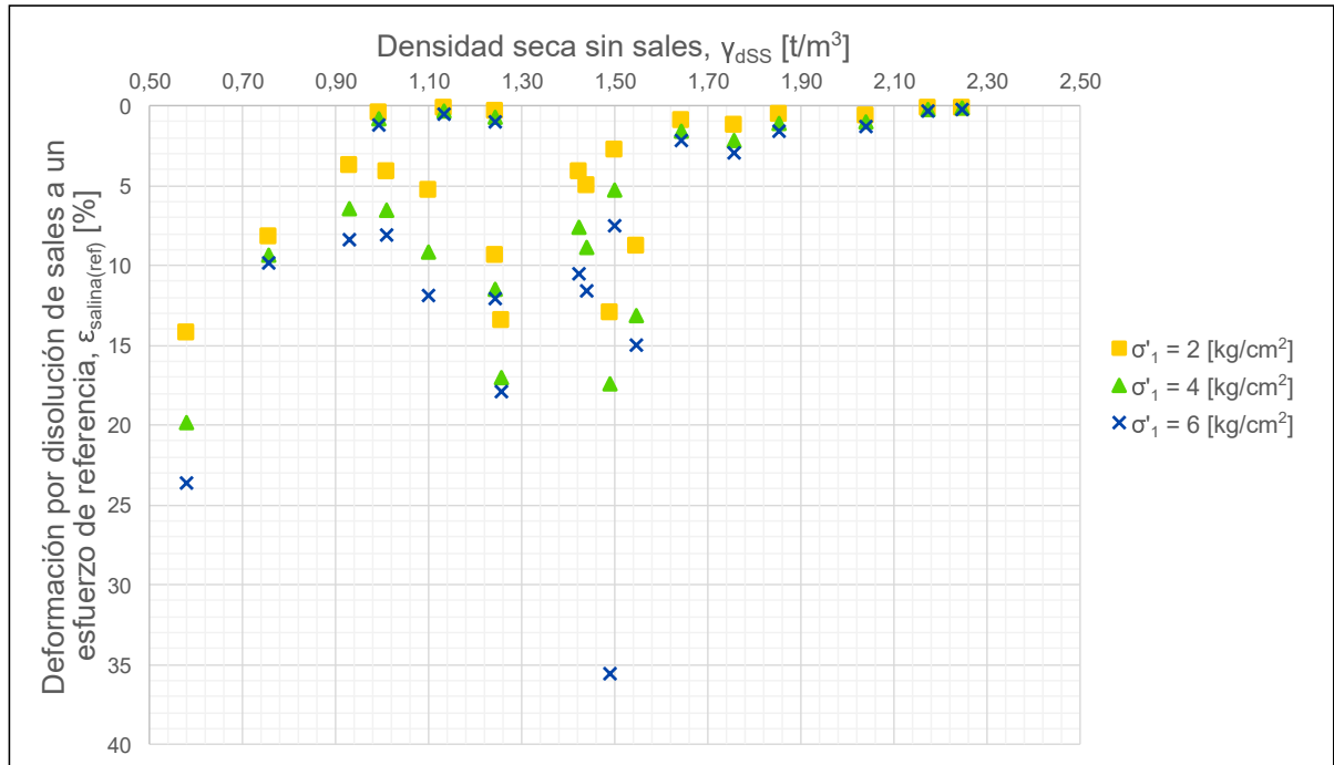
Figura 6.8: Densidad seca sin sales vs deformación por disolución de sales a un esfuerzo de referencia. Campañas A, B y C.
