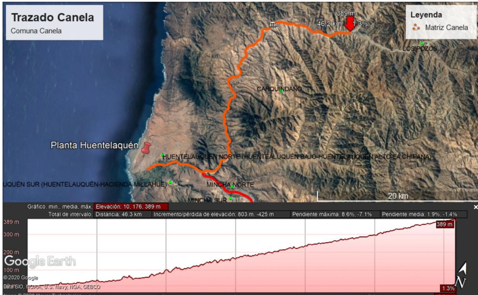
Figura 7.1: Trazado y elevación de la conducción en la localidad de Canela.
