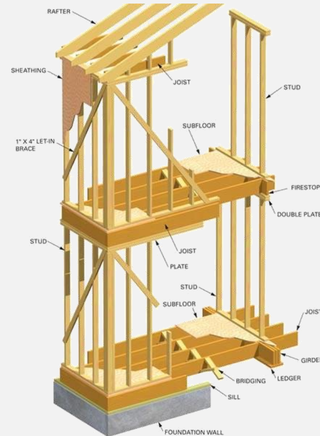
Esquema explicativos sistema Balloon Frame.
