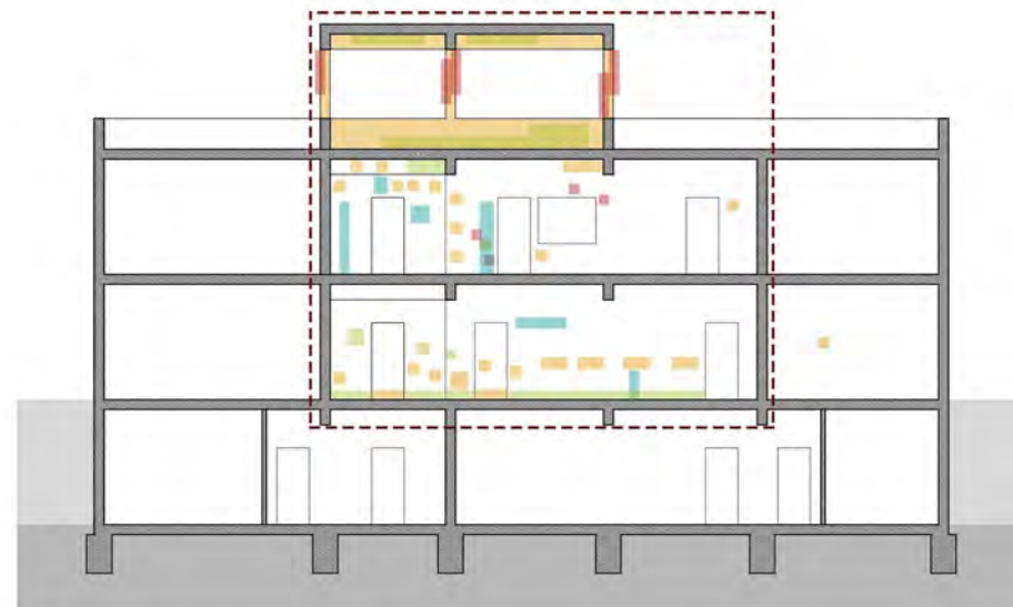
Resumen de lesiones en corte BB' Fuente: Elaboración Propia en base a levantamiento
