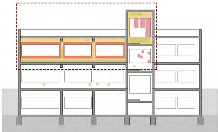
Resumen de lesiones en corte AA' Fuente: Elaboración Propia en base a levantamiento
