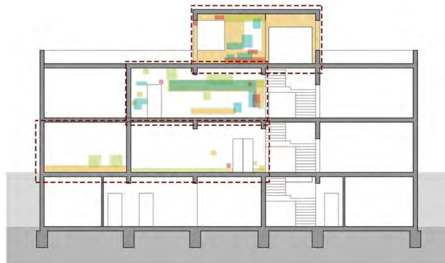
Resumen de lesiones en corte DD' Fuente: Elaboración Propia en base a levantamiento
