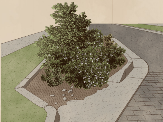
Cuenca de Biorretención. Elab. Propia
