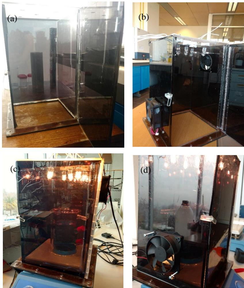
Figura 21. Diseño del reactor fotocatalítico con el arreglo de filtro UV. En (a) se observa la caja de acrílico forrada de lámina filtro UV con la compuerta abierta, en (b) se observa la misma cobertura de acrílico a la que se agregan ventiladores para mejorar el flujo de aire. En (c) y (d) se muestra un ejemplo de arreglo en funcionamiento del reactor de vidrio dispuesto sobre un agitador magnético y que en su parte superior posee un set de luces halógenas de 150 [W].
