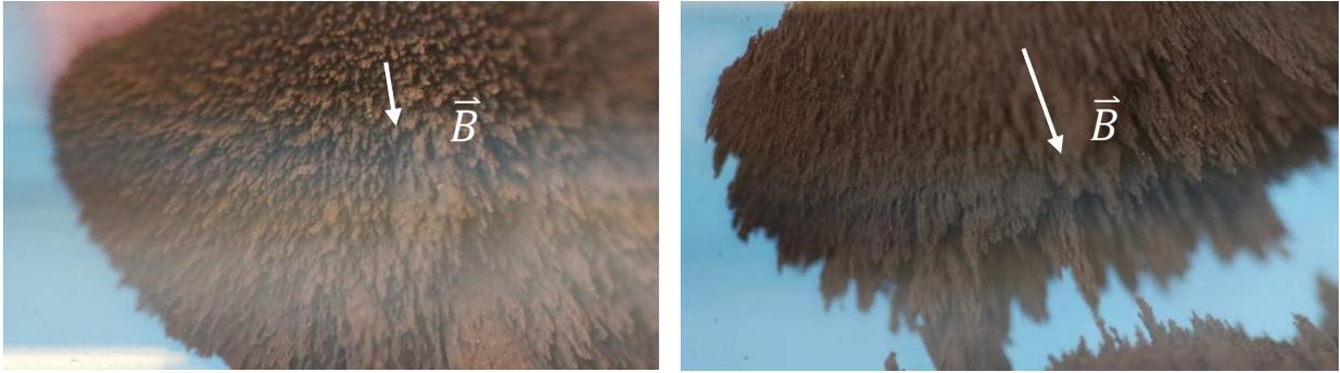
Figura 24. Acercamiento de  $\text{Fe}_3\text{O}_4/\text{TiO}_2$  en presencia de campo magnético.
