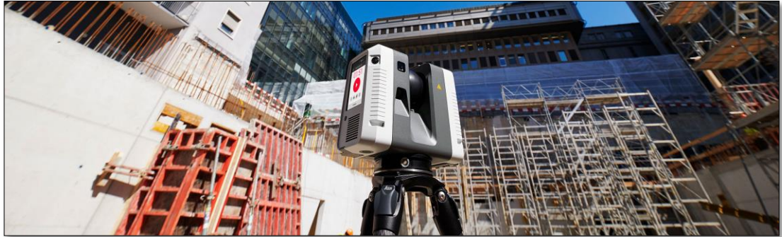
Ilustración 2: Laser escáner 3D Leica RTC 360, en obra, referencial. (Fuente: Leica-geosystem.com).
