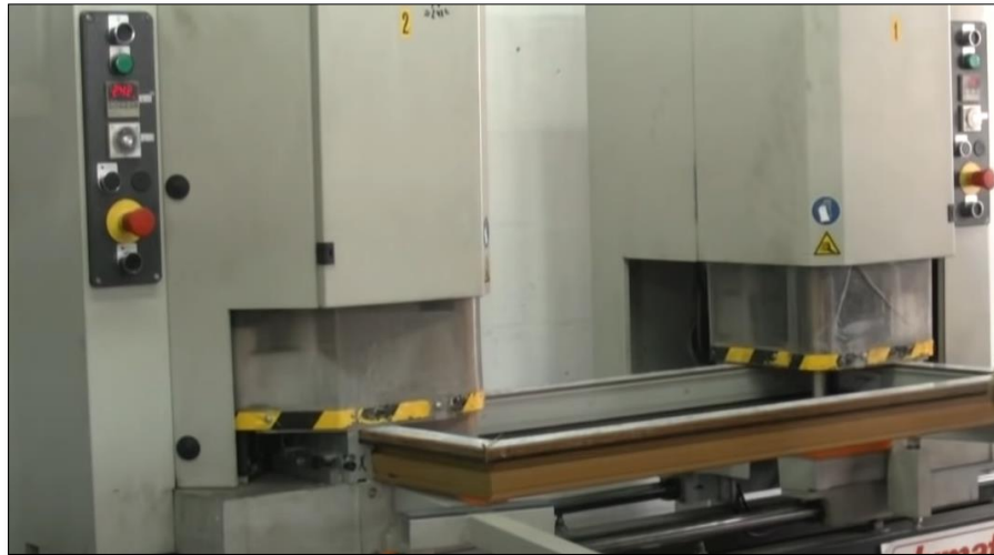
Ilustración 37: Unión de perfiles mediante termofusión. (Fuente: Bersa PVC)
