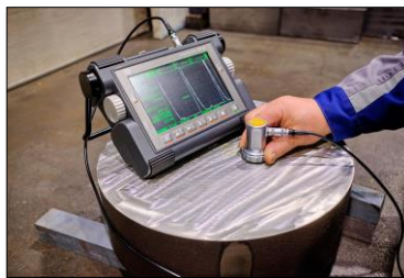
Ilustración 3: Medición ultrasónica, imagen referencial. (Fuente: FINILAGER, servicios de ingeniería, http://finilager.bo ).
