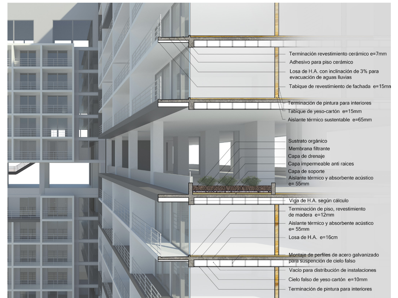
Fig. 47: Escantillón 1 [Figura]. Elaboración propia.
