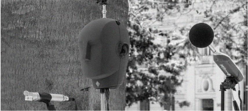
*Fig.4.- Dummy Head Neumann KU 100 utilizada en el registro de paisajes sonoros para el MSS, Fuente: Díaz en Cárdenas & Suárez, 2018.*
