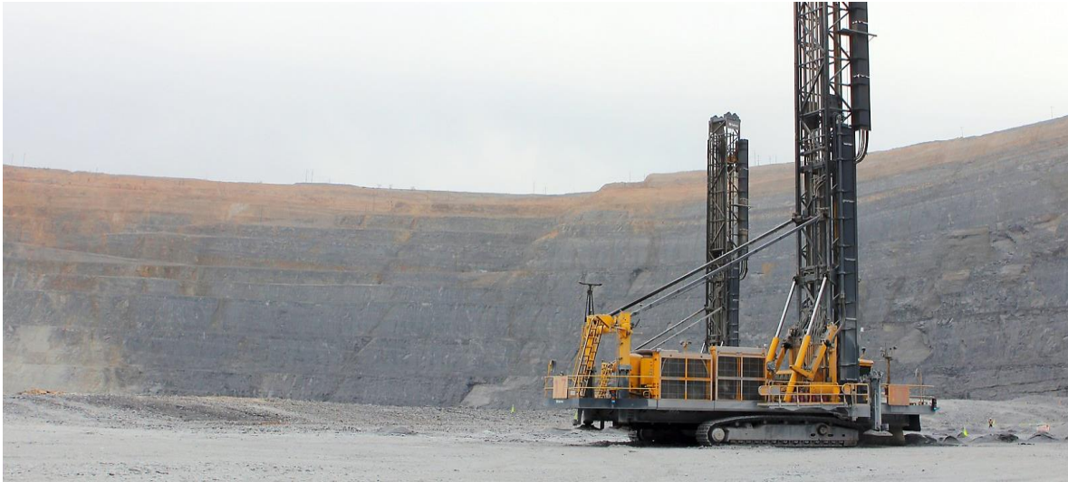
Ilustración 5. Equipo Pit Viper 351 usado en MLP. Fuente: www.epiroc.com
