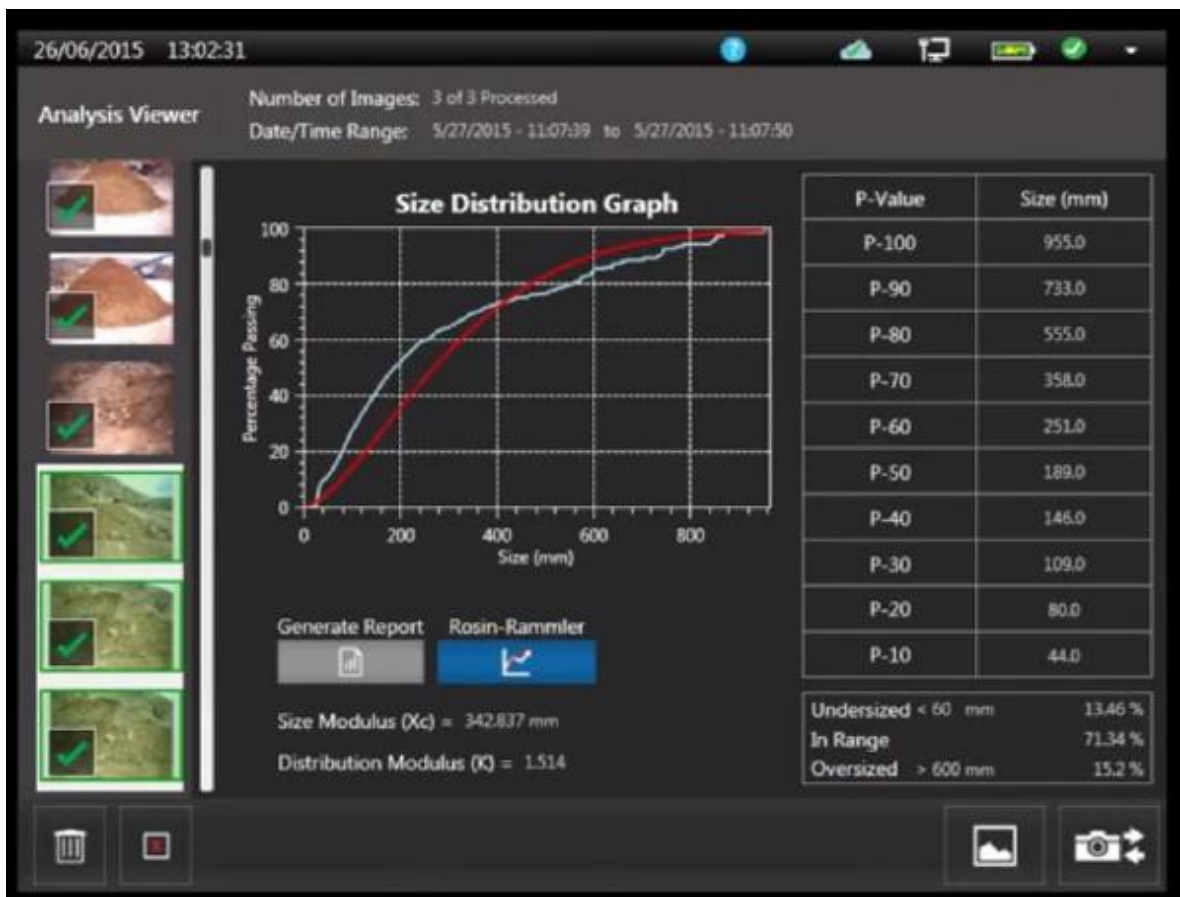
Ilustración 15. La curva granulométrica obtenida se puede exportar en formato xls para un posterior análisis.
