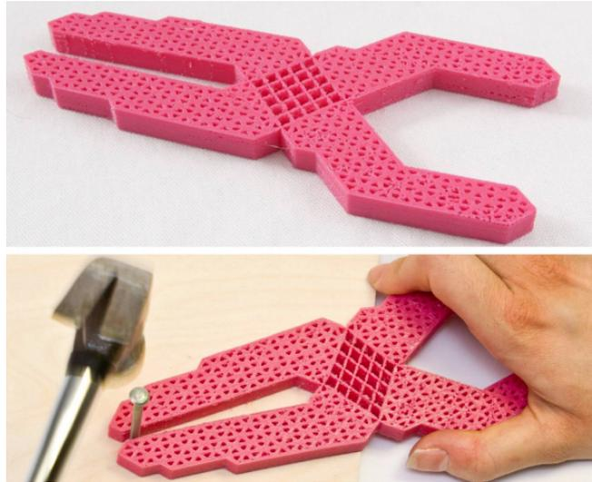
Figura 1.6: Pinza metamaterial. El rombo central transmite la deformación ejercida de un lado a otro [1].
