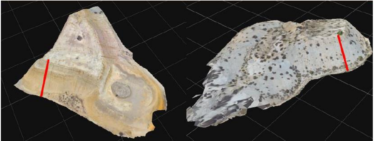
Figura 3.3. Determinación de secciones críticas (líneas rojas) de los taludes de los depósitos de relaves abandonados Delirio 1 y Delirio 2 (Pulgar, 2020).
