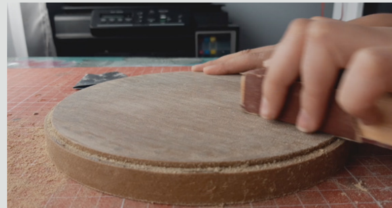
Imagen 58 Lijado de cubierta de pla y madera. Fuente: Elaboración propia, 2021.
