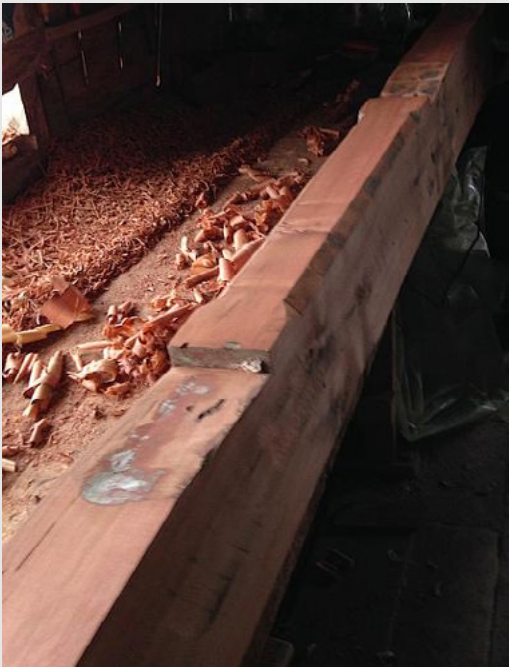
Imagen 60: Madera natural roble pellín, caracterizada por su color café y rojizo. Fuente: https://www.plataformaarquitectura.cl/catalog/cl/products/13556/perfiles-de-madera-nativa-roble-pellin-ecopinturas
