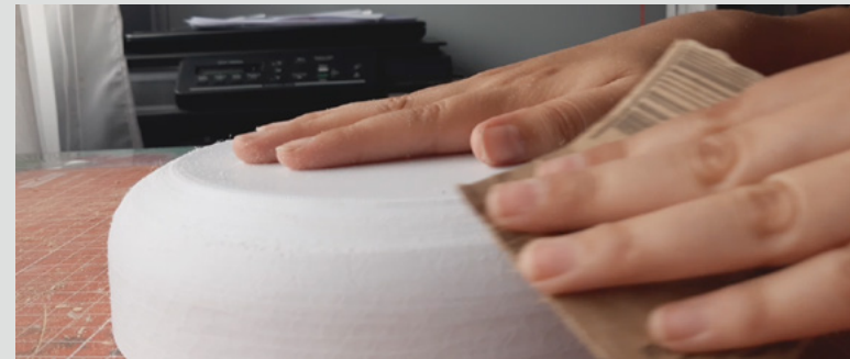
Imagen 57: Lijado de base inferior de pla blanco. Fuente: Elaboración propia, 2021.
