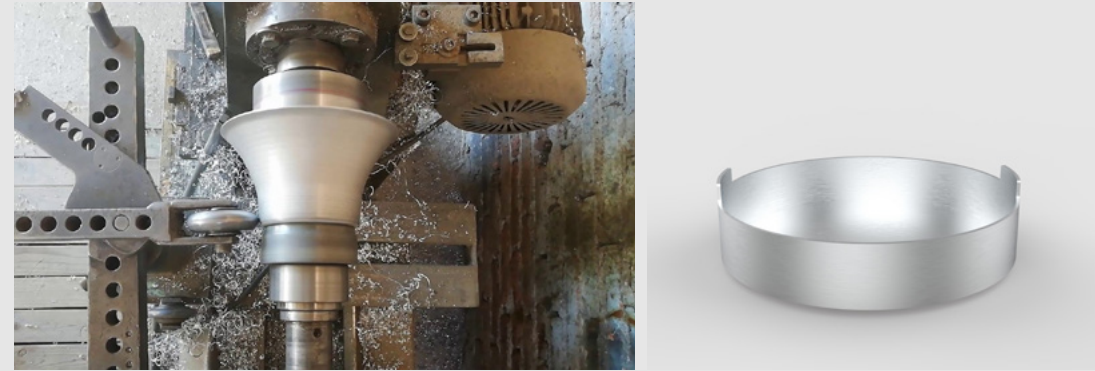
Imagen 68: Desarrollo de pieza de aluminio mediante el proceso de repulsado. Fuente: https://www.youtube.com/watch?app=desktop&v=deo3n0780J8
