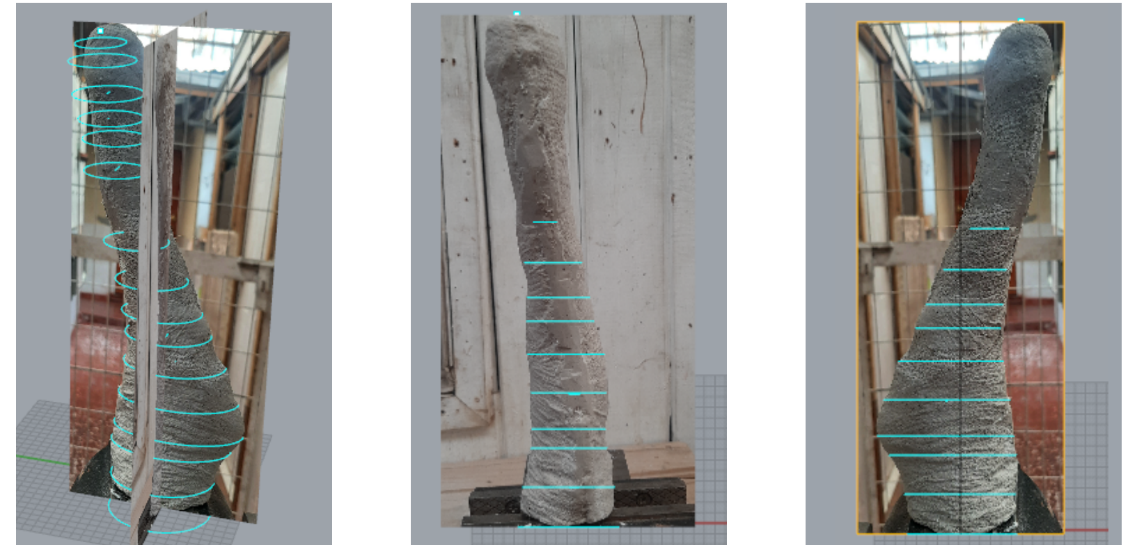
Fotos de derecha a izquierda: Perspectiva, Frontal y Lateral de las elipses dibujadas para generar la geometría del muñón. (Fuente: Autoría propia).
