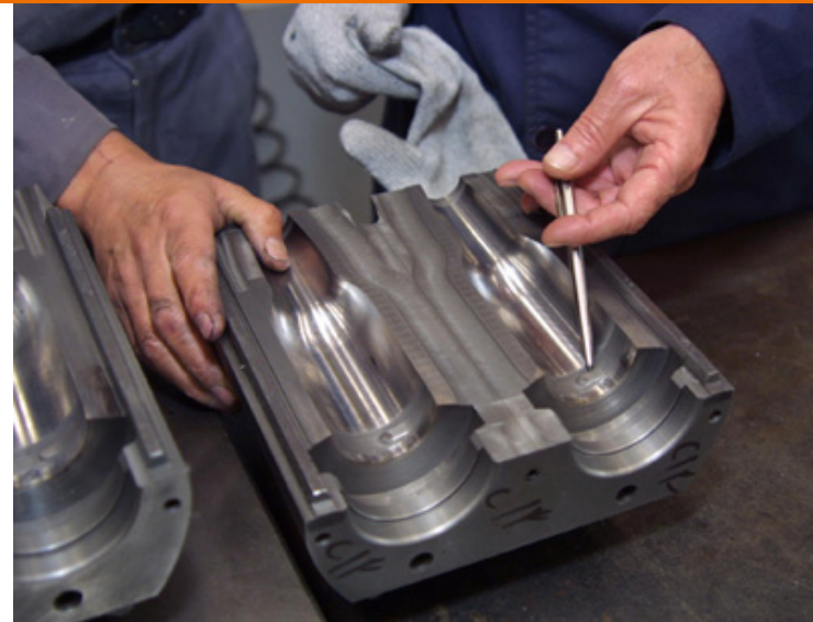
Figura 116: Moldaje de Vidrio
