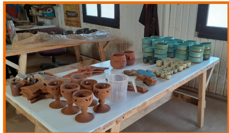
Figura 31: Greda cocida a temperatura de esmaltado, y piezas esmaltadas Fuente: Elaboración propia
