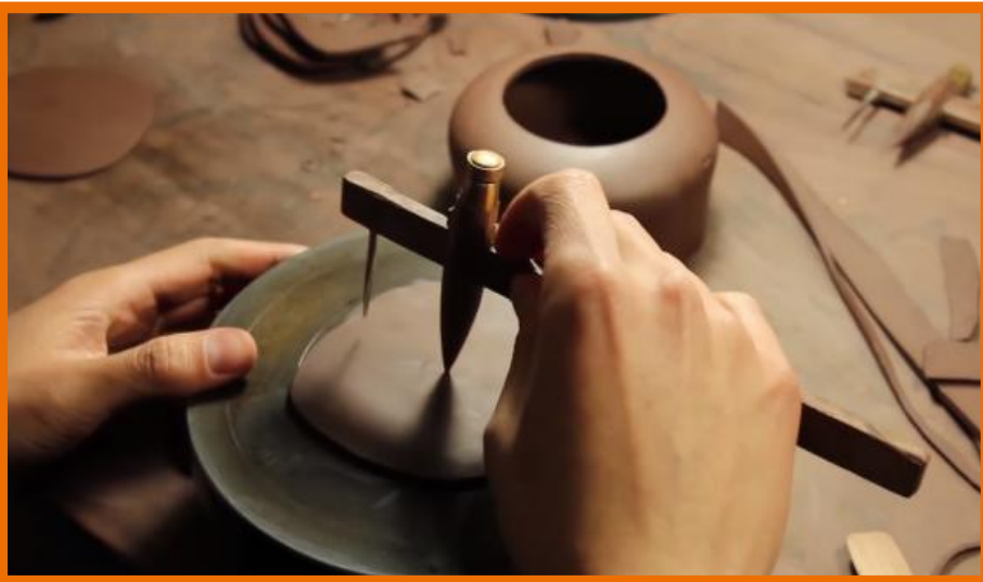
Figura 9: Artista Pan Yang usando un compás de corte para arcilla Fuente: VerdeantTeaChannel . (2016). PanYang hand builds an Yixing Tea Pot
