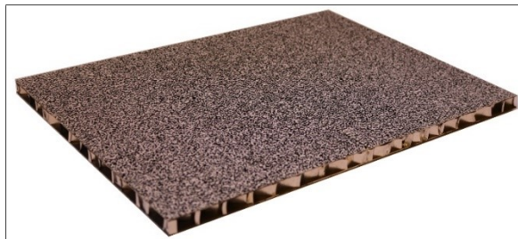
Figura 2.1: Panel compuesto tipo sándwich con núcleo “honeycomb” de aluminio.
