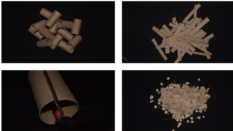
Figura 42. Corte y trituración del sustrato. Fuente: Elaboración propia.
