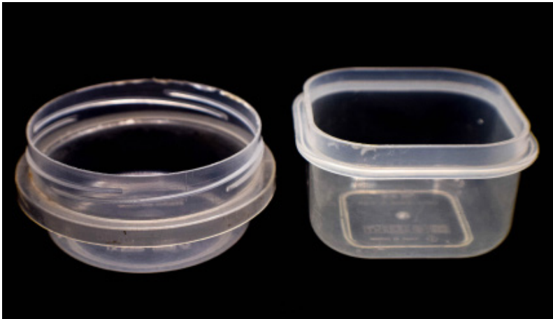
Figura 36. Recipientes plásticos utilizados de molde . Fuente: Elaboración propia.
