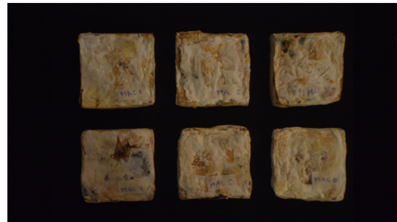
Figura 56. Resistencia a la tracción perpendicular a la superficie. Fuente: Elaboración propia
