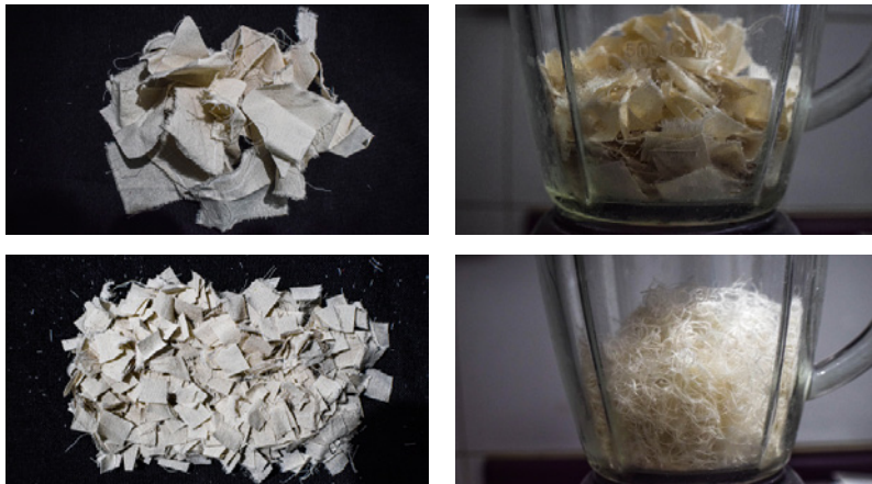
Figura 32. Trituración del sustrato. Fuente: Elaboración propia.
