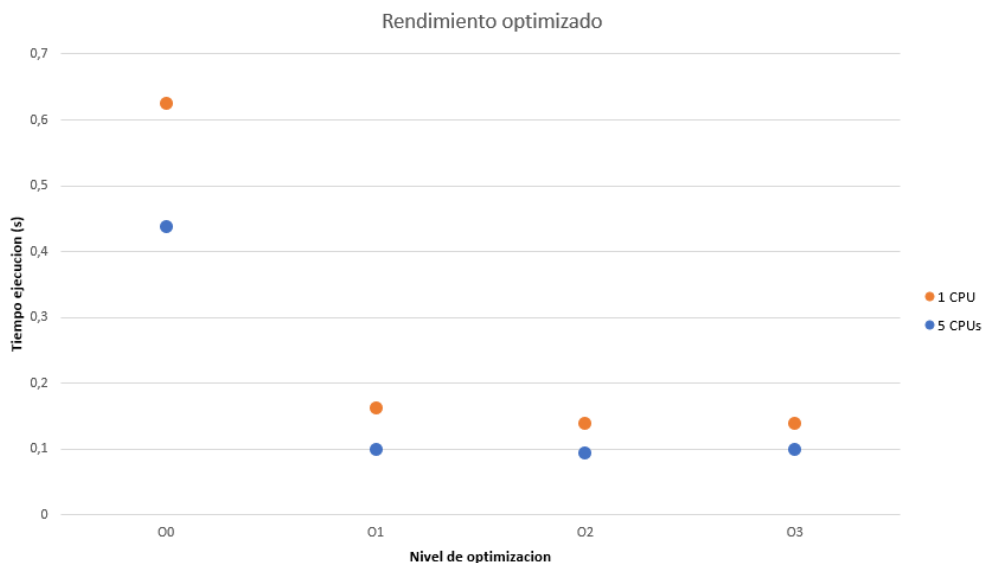
Figura 3.2: Variación del tiempo de ejecución según la optimización del compilador.
