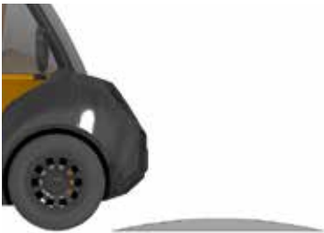
Figura 234: Esquema de despeje en relación a resalto reglamentario (90mm X 1500mm) Fuente: Elaboración Propia.
