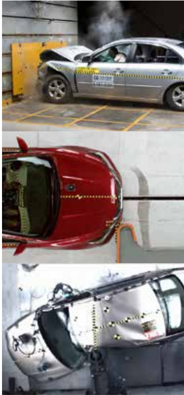
Figura 225: Pruebas de impacto en donde se certifica la indeformabilidad del habitáculo durante colisiones. De arriba hacia abajo: Choque Frontal ( Frontal ), Choque defasado ( Small Overlap ), Choque lateral ( Pole Test ).
