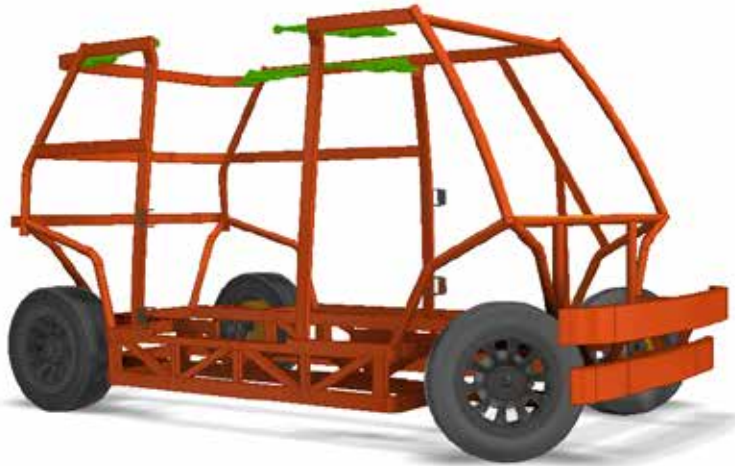
Figura 220: Visualización 3D de conjunto mecánico del vehículo. Fuente: Elaboración Propia.
