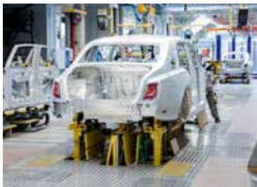
Figura 235: Ejemplo de chasis de aluminio. Vehículo Roll Royce Phantom. Fuente: www.autocar.co.uk
