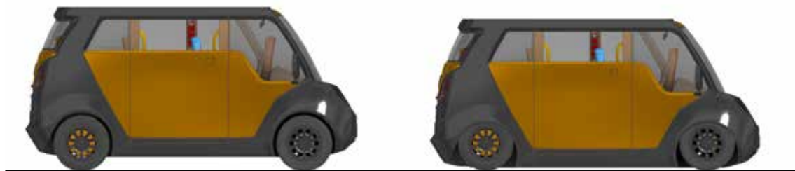
Figura 224: Secuencia en donde se aprecia la altura variable neumática de 140mm. Fuente: Elaboración Propia
