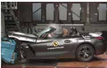
Figura 179: Activación de Airbag conductor en pruebas de impacto.
