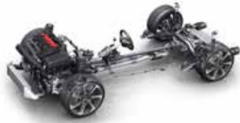
Figura 196: Sistema motriz de auto a combustión.
