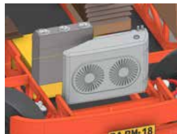
Figura 176: Disposición del conjunto de Aire acondicionado en la parte frontal del vehículo. Fuente: Elaboración Propia
