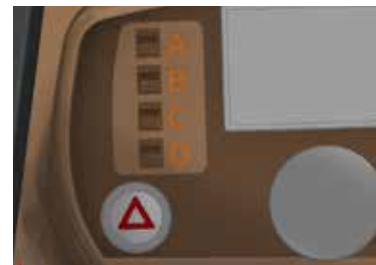
Figura 182: Botonera para apertura y cierre automático de puertas.
