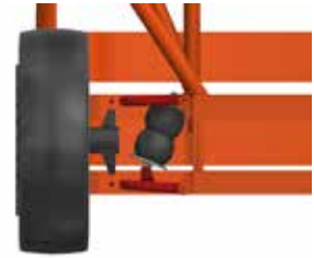
Figura 222: Imagen sistema doble bandeja en vehículo. Fuente: Elaboración Propia
