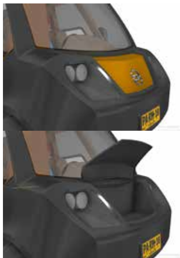
Figura 245: Secuencia de apertura de puerta auxiliar delantera. Fuente: Elaboración Propia.
