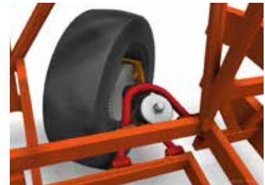
Figura 223: Visualización 3D de suspensión en el concepto. Fuente: Elaboración Propia
