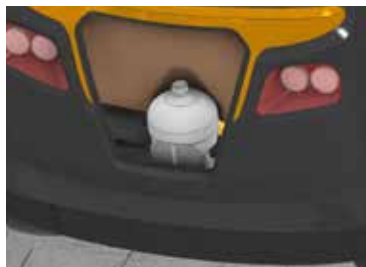
Figura 193: Puerta trasera para acceder al botellón de 20 litros ubicado en la parte trasera del vehículo. Fuente: Elaboración Propia
