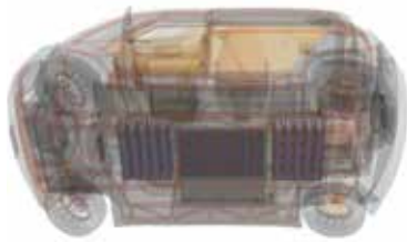
Figura 204: Ubicación del banco de baterías en la parte inferior del vehículo.
