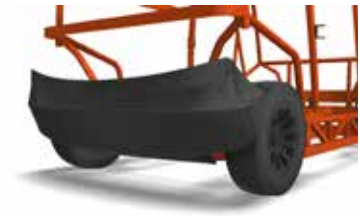
Figura 232: Parachoques plástico para impactos de baja velocidad. Fuente: Elaboración Propia
