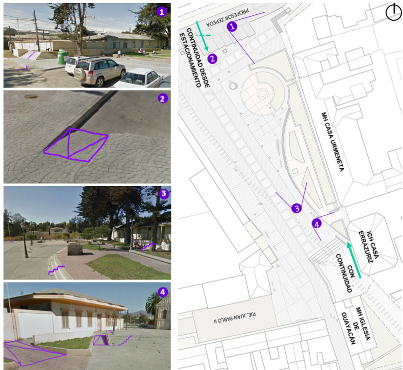
[Figura 194]. Levantamiento de rampas y desniveles en el área fundacional de Guayacán. Elaboración propia.
