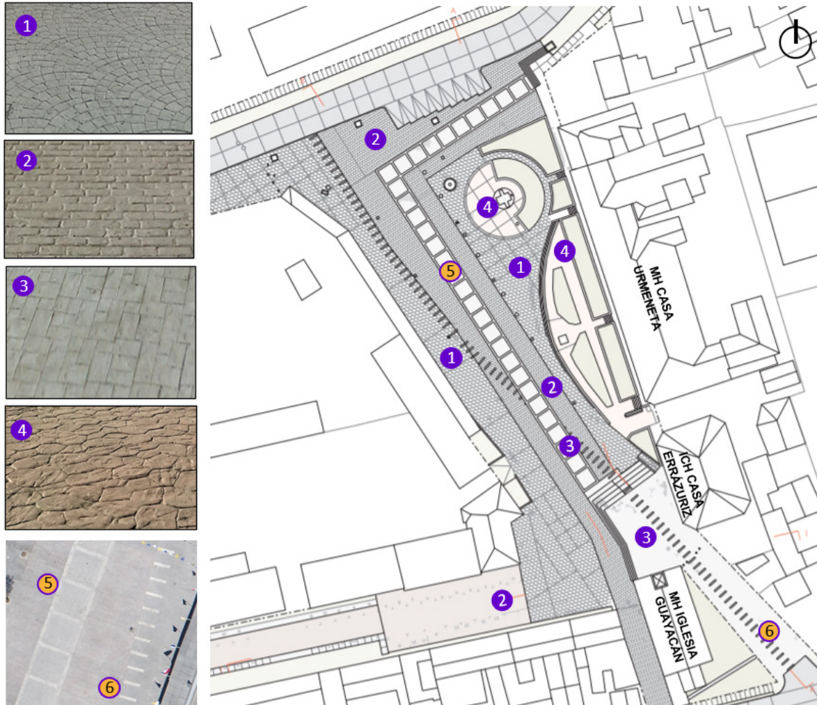
[Figura 157]. Levantamiento de pavimentos en el área de intervención. Elaboración propia.
