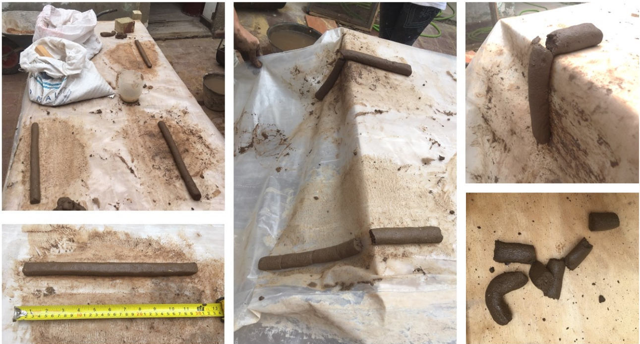
Fig. 39 Prueba de plasticidad. En la foto central se puede observar como la tierra del caso estudio se rompe en tramos más cortos que la otra. En las fotos a la derecha se observa como la tierra de Jaururo se parte regularmente cada 10 cm aprox.
