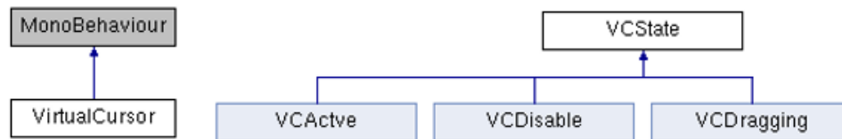
Figura 4.3: Diagrama de herencia de las clases VirtualCursor y VCState .
