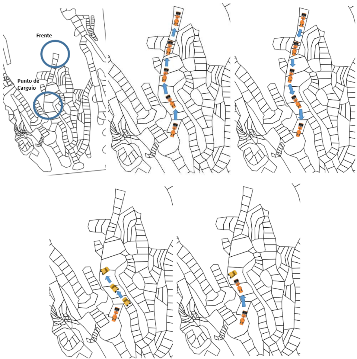
Figura 17: Ejemplo 2 de circuito de carguío.
