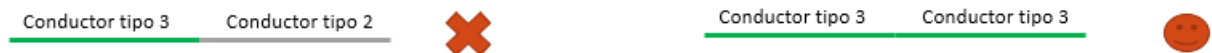
Figura 3.4: Líneas conectadas deben tener el mismo tipo de conductor para ser candidatas a transformarse en una sola línea.
