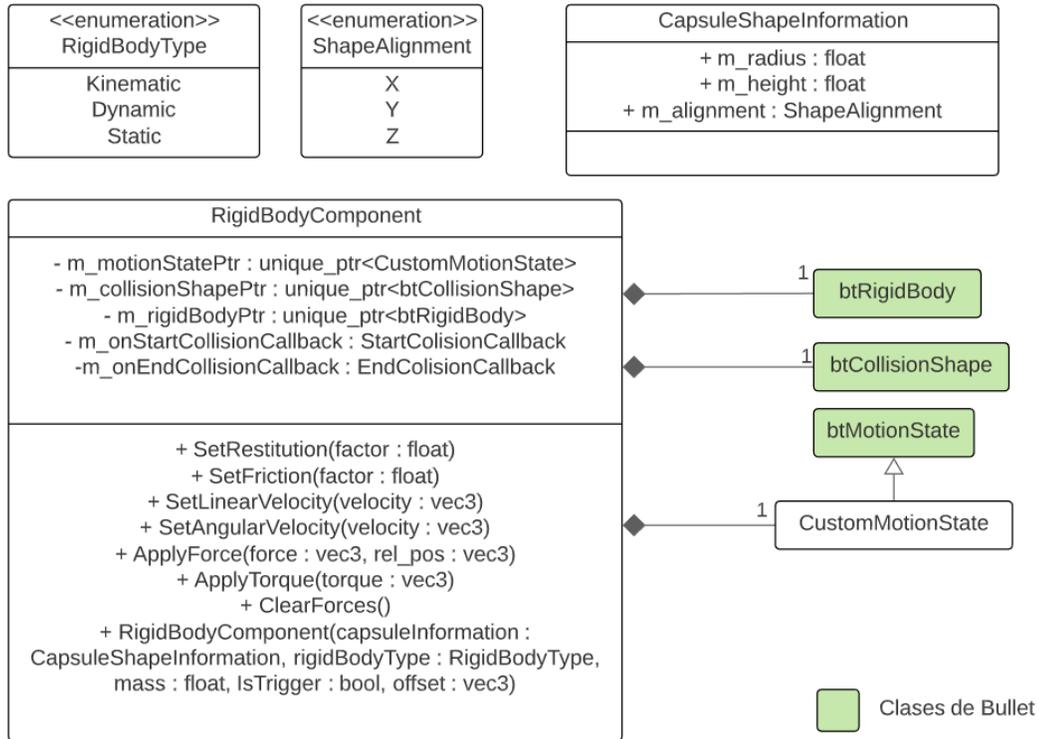
Figura 3.37: Diagrama de la clase RigidBodyComponent.
