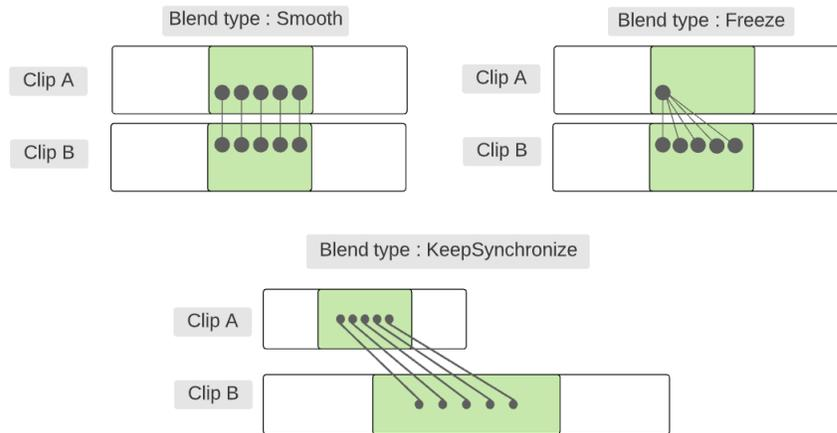
Figura 3.34: Relación entre las muestras para los distintos tipos de *blending*. El clip A representa la animación principal mientras que el clip B a la que se está haciendo la transición.
