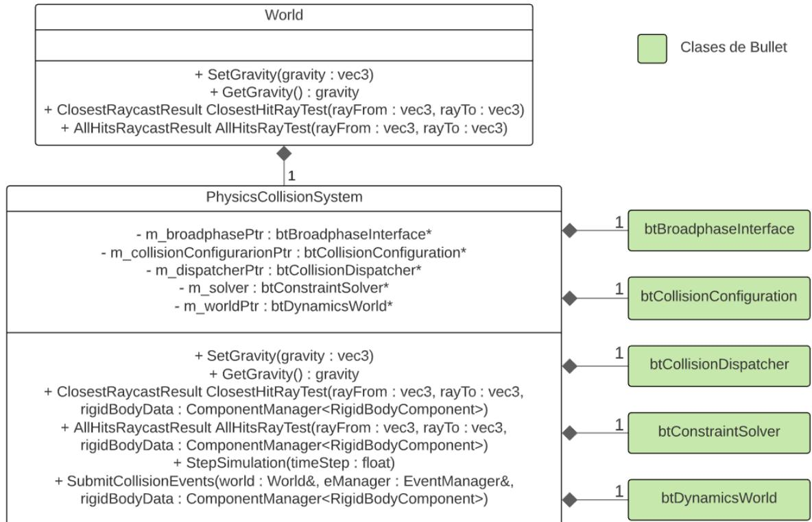
Figura 3.38: Diagrama de la clase PhysicsCollisionSystem.
