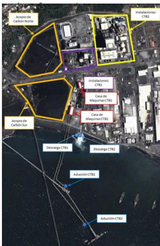
Figura 4 CTB Puntos de almacenamiento, succión y descarga Bocamina 1 (CTB1) y Bocamina 2 (CTB2), patios de almacenamiento de combustible (carbón bituminoso), las correas de transporte de dicho carbón desde las instalaciones de descarga en cabo Froward a los patios de acopio y la subestación eléctrica S/E Bocamina. Puntos de aducción y descarga de CTB1 y CTB2. (-37.025612, -73.167476).
