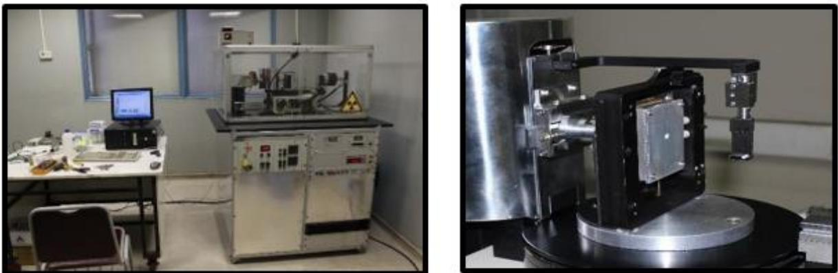
*Figura 15. Difractómetro STOE Stadi P y Portamuestras para difracción de rayos X en función de la temperatura.*
