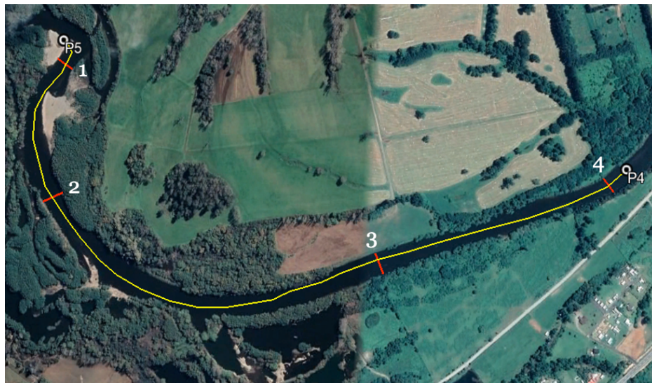
Figura 3-5: Ejemplo de medición del ancho del cauce en el segmento 4 en Google Earth . Se consideraron 4 secciones que luego se promediaron, obteniéndose el ancho final de dicho segmento.
