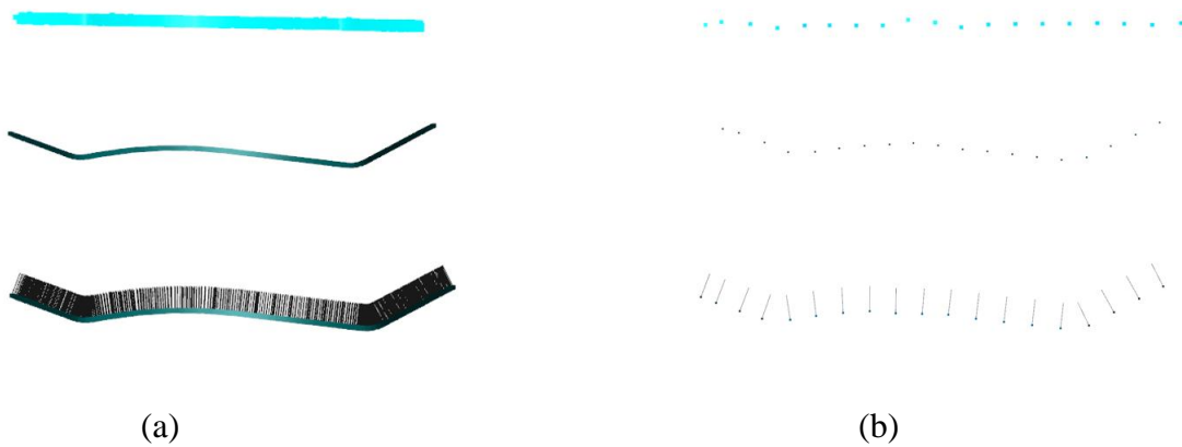
Figura 4.15 (a) sección de la nube de puntos y (b) recorrido generado a partir de ella.
