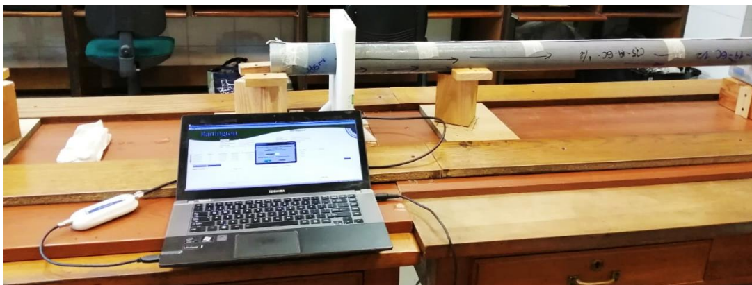
Figura 5.10: Mecanismo para la medición de susceptibilidad magnética en testigos sedimentarios. Fotografía propia.
