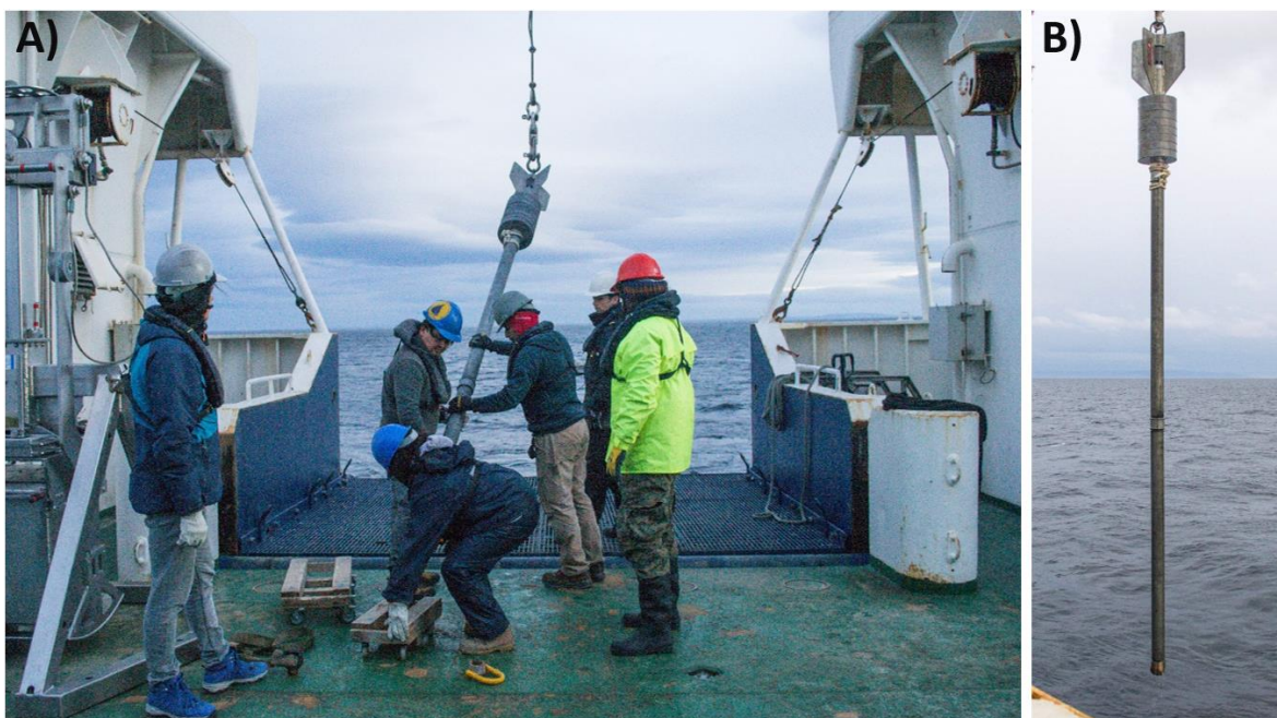
Figura 5.3: Gravity corer. A) Posicionamiento de gravity corer previo al muestreo durante CIMAR-25. B) Estructura de un gravity corer. Fotografías propias.
