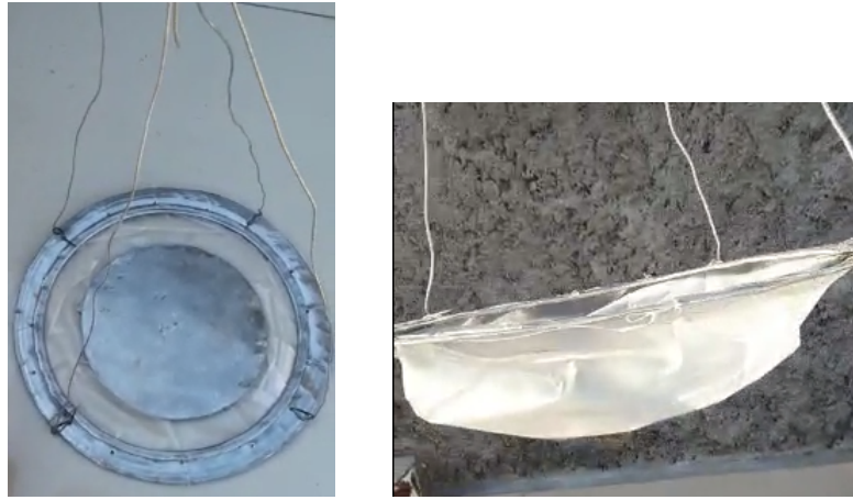
Figura 3.6: Izquierda: Muestreador plano, Derecha: Muestreador levantado como cubeta.
