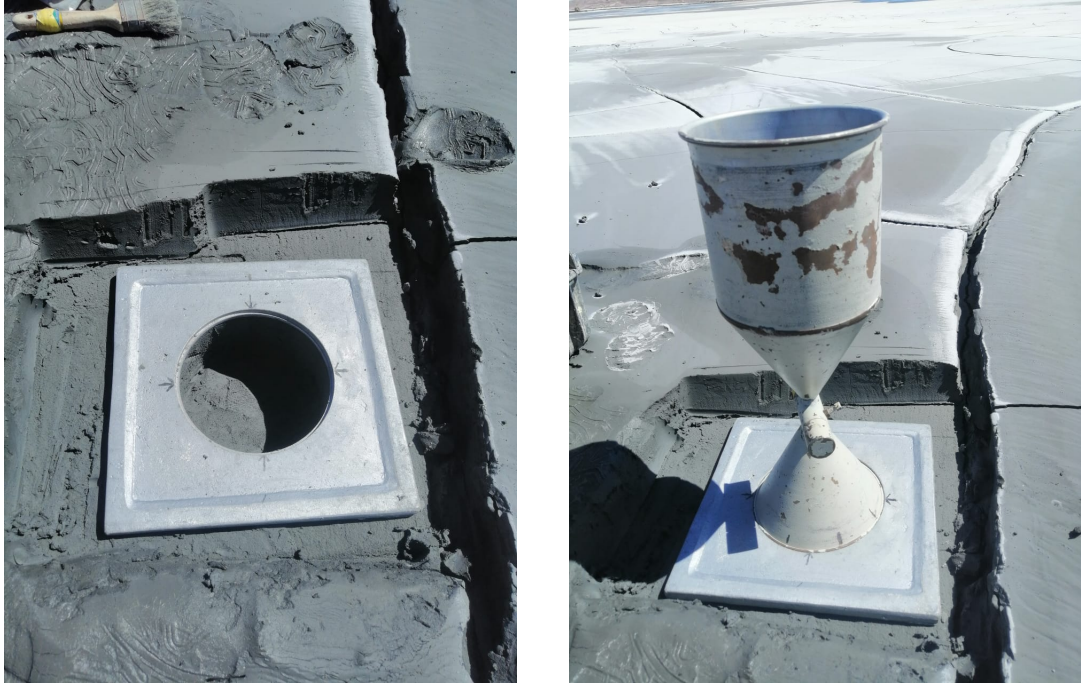
Figura 4.17: Izquierda: Lámina situada en capa previa para realizar cono de arena, Derecha: Cono de arena.
