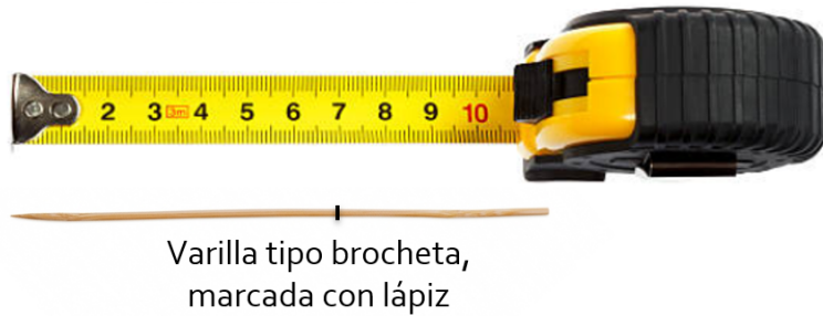
Figura G.4: Medida de altura de capa con brocheta y huincha.
