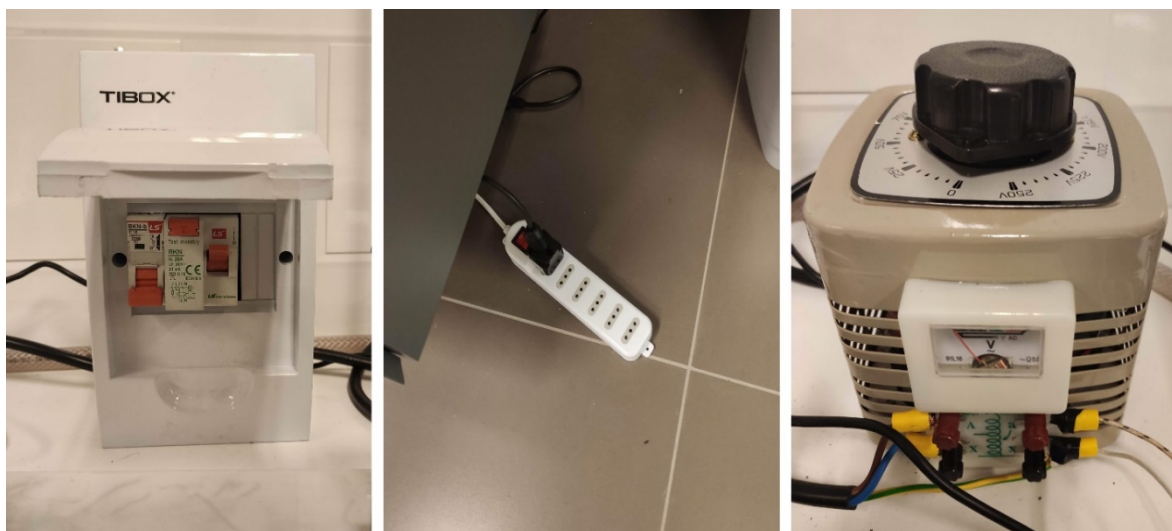
Figura 55: Revisión del equipo Izq.: Tablero de seguridad con el automático apagado. Centro: Extensión eléctrica apagada. Der.: Regulador de voltaje en cero.
