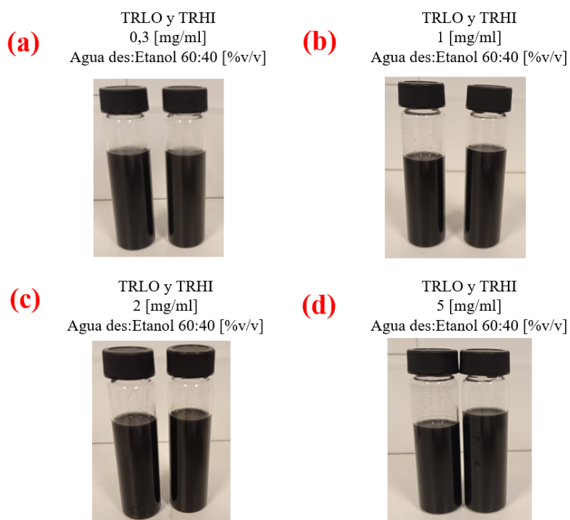
Figura 61: Imagen digital de disoluciones de RGO inmediatamente luego de un baño de ultrasonido de 1 [hr]. Se ordenan en orden creciente de concentraciones desde (a) hasta (d). TRLO en izquierda de cada foto y TRHI derecha de cada foto.
