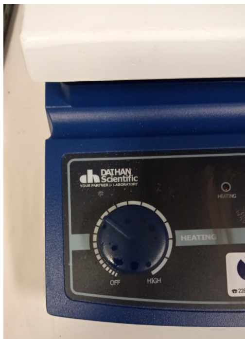
Figura 51: Referencia para establecer 120 [°C] en plancha calefactora.
