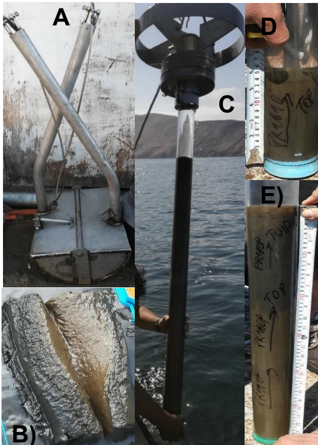
Figura 2-1 A) Draga. B) Muestra obtenida con draga. C) Rumöhr con testigo adosado saliendo del agua. D) Testigo PR1810. E) Testigo PR1809.
