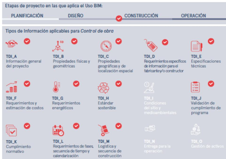
Ilustración 41 Tipos de información para el uso control de obra. Fuente: Estándar BIM, PlanBIM
