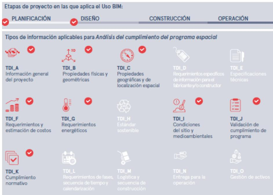
*Ilustración 26 Tipos de información para el uso análisis del cumplimiento del programa espacial. Fuente: Estándar BIM, PlanBIM.*
