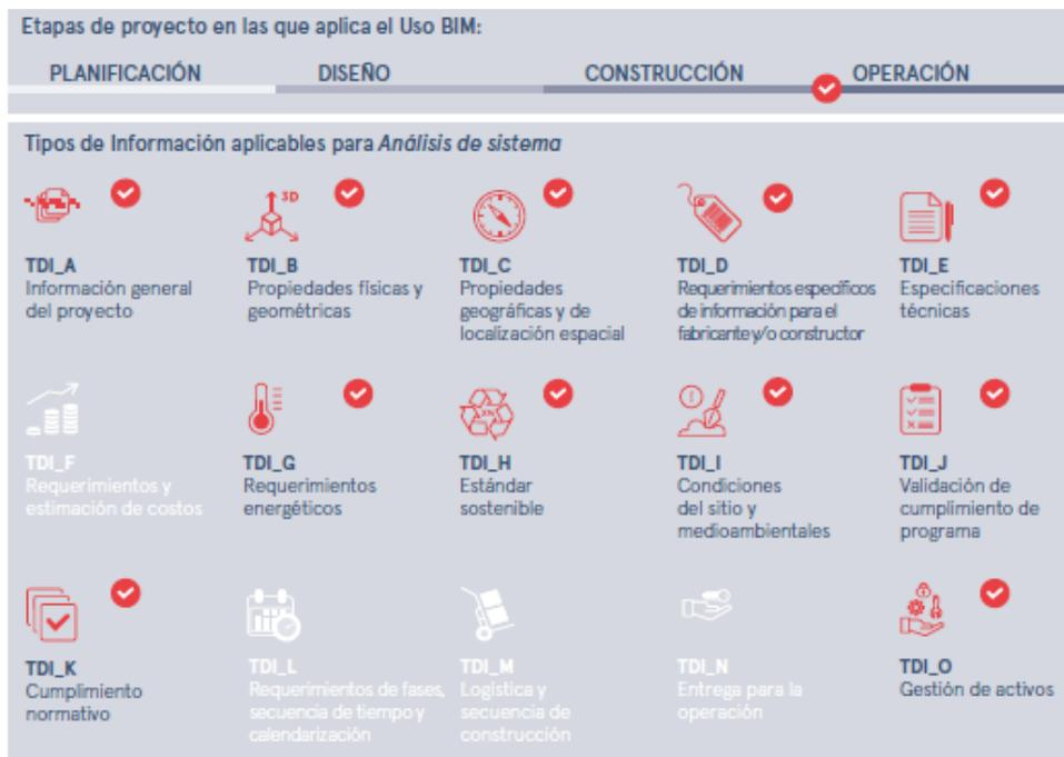
*Ilustración 44 Tipos de información para el uso análisis de sistema. Fuente: Estándar BIM, PlanBIM*
