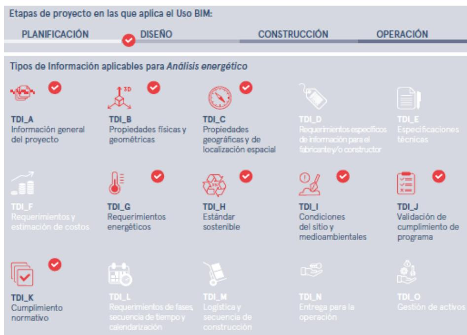
*Ilustración 33 Tipos de información para el uso análisis energético. Fuente: Estándar BIM, PlanBIM*
