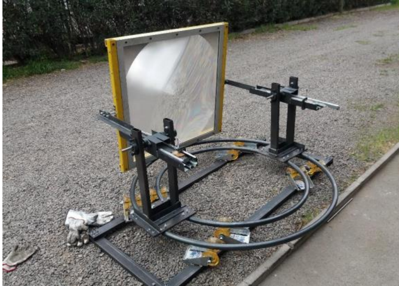
Figura 10: Sistema de concentración solar desarrollado por el otro alumno memorista. [3]
