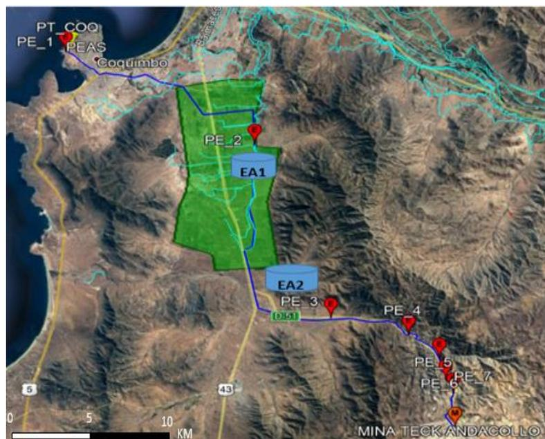
Figura 31: Trazado y PEAS para sistema de reúso de aguas servidas tratadas emisario submarino Coquimbo.
