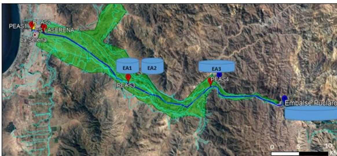
*Figura 28:* Trazado y PEAS para sistema de reuso de aguas servidas tratadas emisario submarino La Serena.
