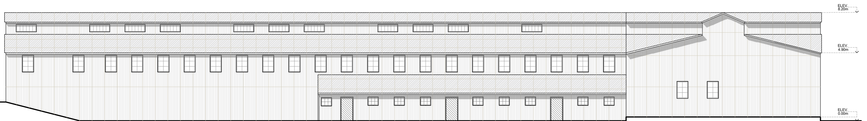
Elevación Oeste Galpón de Esquila Escala 1:200
