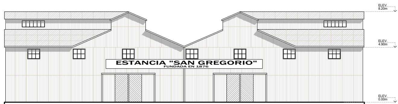
Elevación Sur Galpón de Esquila 1876-1924 Escala 1:200
