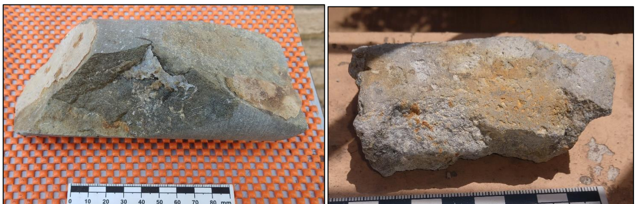
Figura 48. Izquierda: Muestra PEM-03-13 con pátina de calcita en una de sus fracturas. Derecha: PEM-03-19 con box-work de pirita en sus caras.
