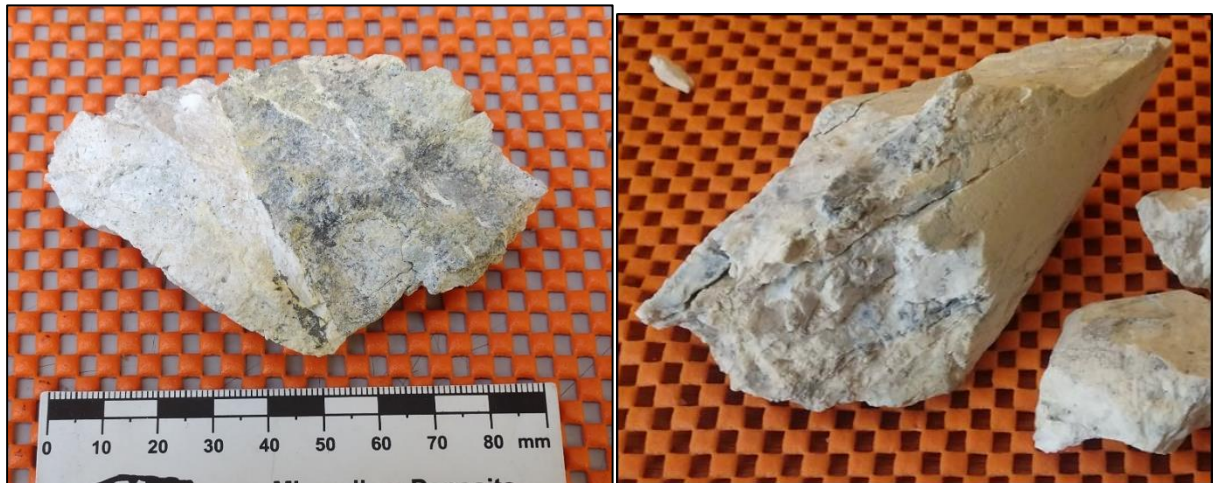
Figura 46. Muestra PEM-03-01 a la izquierda y PEM-03-03 a la derecha. Muestras alteradas a arcillas con protolito completamente obliterado.
