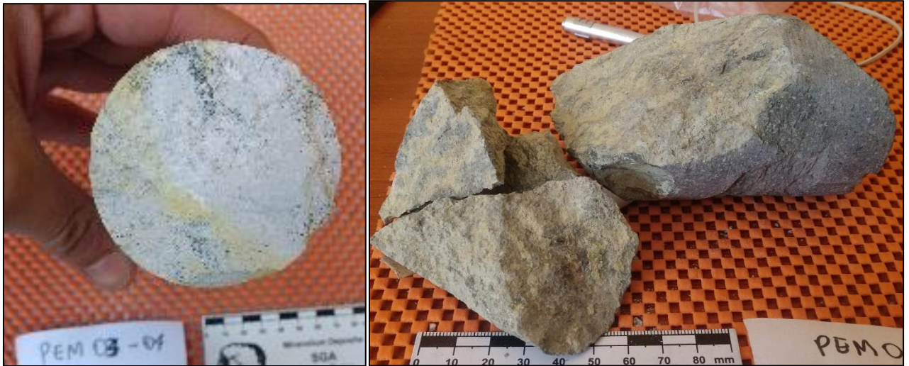
Figura 47. Izquierda: Minerales oscuros-verdosos en corte de muestra PEM-03-04. Derecha: Cambio notorio en la litología y grado de alteración posterior a los ~ 200 [m], muestra PEM-03-10.
