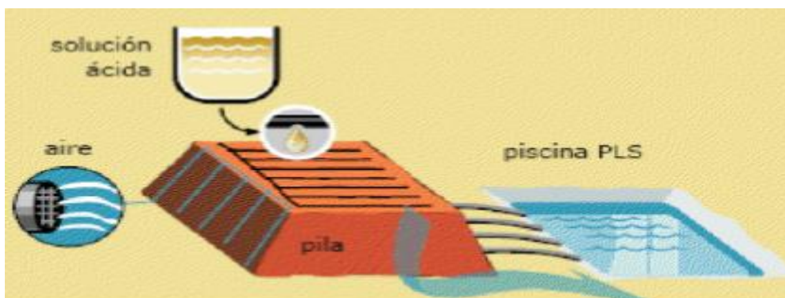
Figura 4: Esquemas lixiviación en pilas
