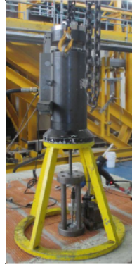
Figura 3.3: Equipo utilizado ensayos de tracción.
