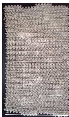
Figura 6.21: Impresión en resina dental en la que se observa separación de capas.
