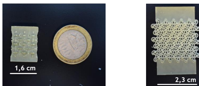
Figura 6.16: Estructuras impresas en resina dental sin curar (a) Semi-rígida cuadrada (b) Kagome triangular.
