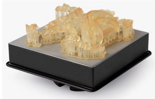
Figura 5.10: Impresión realizada en resina dental [10] .
