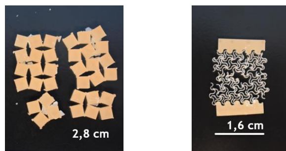
Figura 6.17: Estructuras impresas en resina dental curada (a) Semi-rígida cuadrada (b) Kagome triangular.
