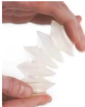
Figura 5.11: Objeto fabricado con resina elástica [10] .
