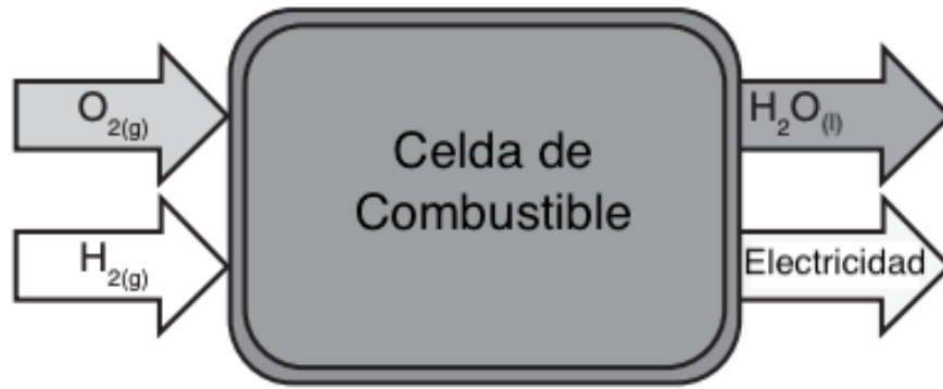
Figura 1.3: Esquema general de una celda de combustible de electrolito ácido.
